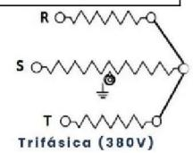
ATENCIÓN: Nunca opere la resistencia en seco. ¡Los elementos calefactores deben cubrirse completamente con agua antes de ponerlos en funcionamiento!
